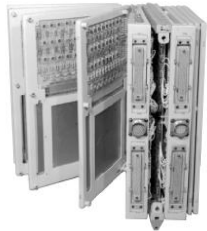
Блок ОЗУ-1 Оперативное запоминающее устройство на цилиндрических магнитных пленках
