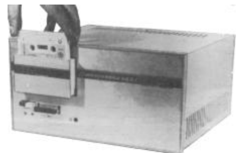
КНМЛ Кассетный накопитель на магнитной ленте в компакт-кассете
